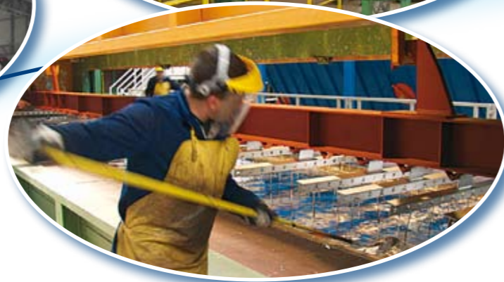
Cynkowanie ogniowe – zgodne z normą PN-EN ISO 1461
