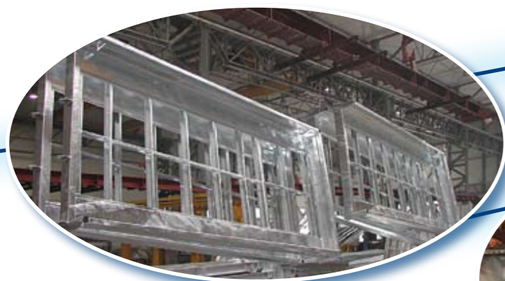
Cynkowanie ogniowe – zgodne z normą PN-EN ISO 1461
